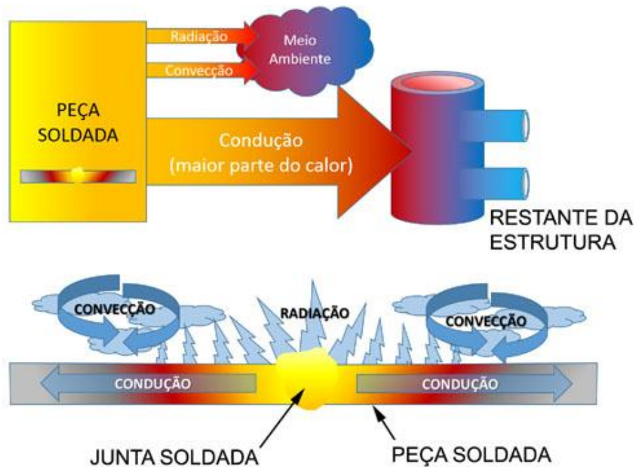
Figura 1. Esquema ilustrando as três formas pela qual uma junta soldada (parte inferior da figura) dissipa a sua energia térmica (calor): convecção, radiação e condução. (Fonte: MORAIS e FERNANDES, 2014).
